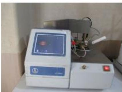
از کاهش گرانزوی روغن های موتور به میزان ۱۰٪ مقدار اولیه به وجود سوخت مشکوک شده و آزمایش FP را انجام می دهیم.
